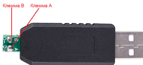
Рисунок 3 - Распиновка разъема RS-485 на адаптере
