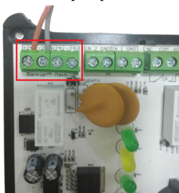
Рисунок 1 - Разъем основного и резервного питания ППК
